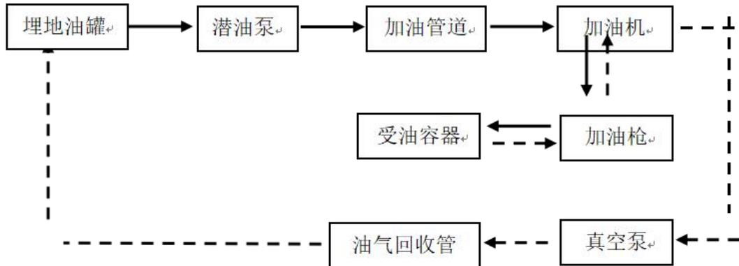
柴油加油机加油工艺，流程图如下：
